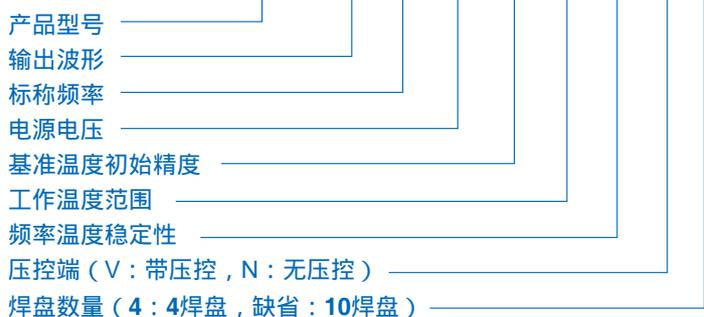
注：字母V加数字“5”、“3”，分别表示电压要求“5.0V”、“3.3V”。可以根据客户要求，按双方协议设计生产。
